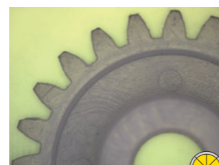
樹脂部品(光学0.35x) タイプAズームヘッド/8分割リング照明
