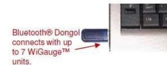
2. オプション：付属の Bluetooth ドングルをラップトップに差し込みます。この dongle はソーラトロン Wi ゲージでテストされており、最も効率的に機能します。
