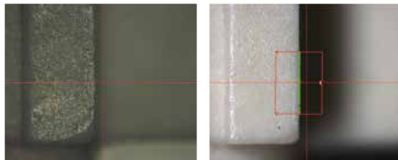
落射照明では、エッジが見えにくい測定部位
