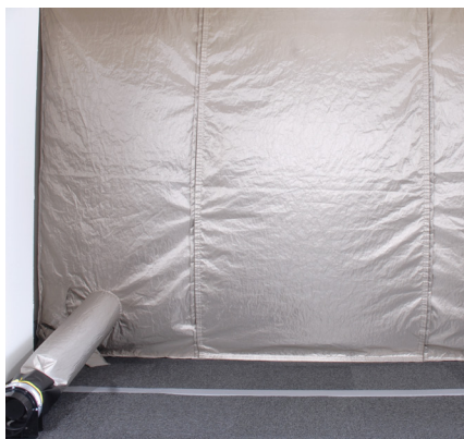
正面扉 シールドテント 閉口時
