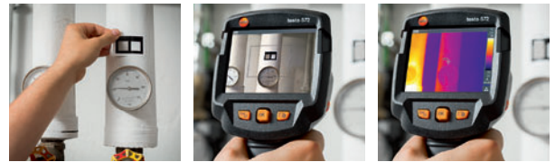
専用マーカーを対象物に貼ります。可視カメラでマーカーを検知し、放射率と反射温度を自動設定します。より正確な温度を測定できます。
