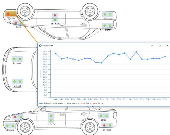
「不合格ゾーン」と過去 20 測定履歴を表示する、ドリルイン機能
