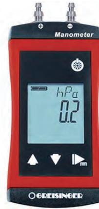
G1107/1113は、空調管理システムでの利用に適したコストパフォーマンスの高い差圧計です。G1107の測定範囲は最大200hPa、最小分解能は0.1Paと高精度で、動圧の補正やドラフトの測定を簡素化することができます。ねじ込み継手やワンタッチ継手、プッシュプル式などの様々な接続方法に対応できるよう、交換可能なユニバーサル圧力ポートを採用しています。
