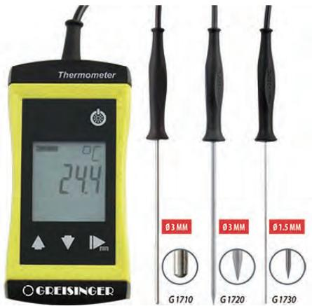
G1700シリーズはPt1000センサを使ったプローブ一体型の防水温度計です。プローブは用途に合わせた3種類の形状があります。本体・プローブともに防水仕様で、工業用途、実験、食品検査などの様々な用途で使用できます。本体は小型で手にフィットする持ちやすい形状で、表示を上下反転することもでき、使いやすさを重視した設計です。
