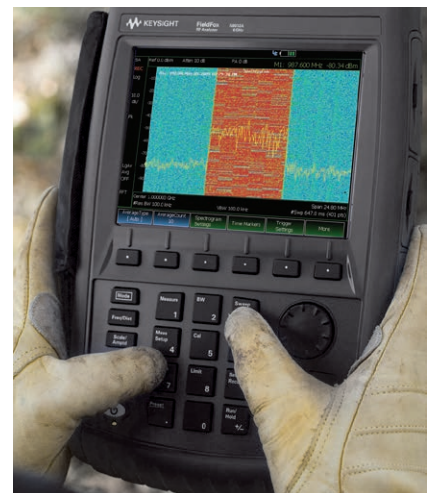
グローブを装着している状態でも操作しやすい大型のフロント・パネル・キー
