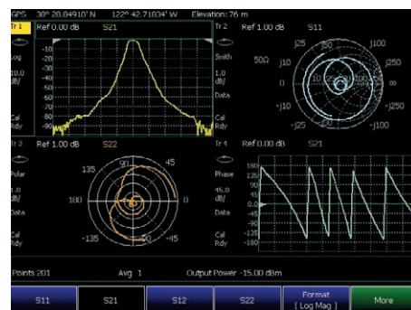
1回の接続で4つのSパラメータすべてを同時に測定／表示
