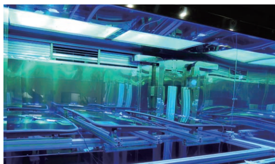
照射試験サービス実施例 (自動車用サンルーフユニットの促進耐候性試験)
