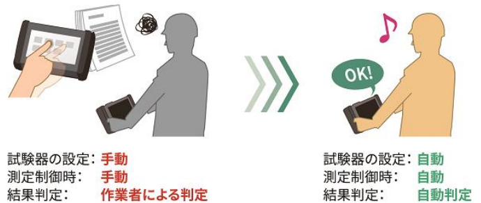
MT1000Aシナリオ自動による試験作業
