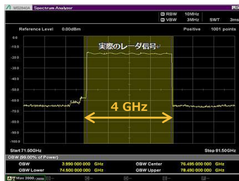
図4-3 4 GHz帯域幅のチャープ信号の 占有周波数帯幅の測定例 <PS機能を使用>
