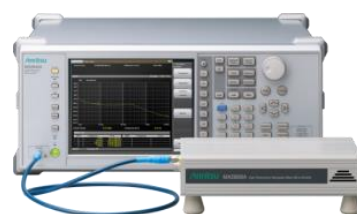
図4-2 MS2840AとMA2808A 周波数範囲：60 GHz～90 GHz
