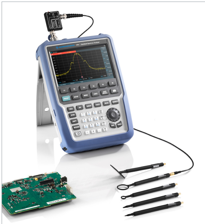
近磁界プローブを接続したR&S®Spectrum Rider FPHとDUT
