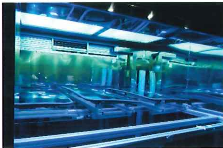
照射試験サービス実施例(自動車用サンルーフユニットの超促進耐候性試験)
