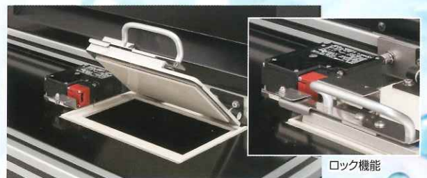
試材のセットも簡単。ロックがかからないと稼働しない安全設計
