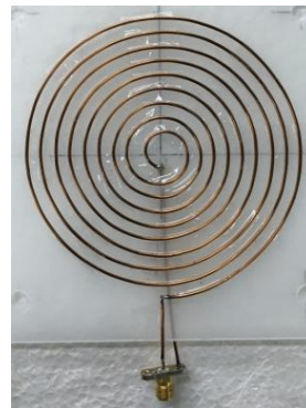
直径100mm 銅線コイル (銅線 \Phi = 1\text{mm} )
