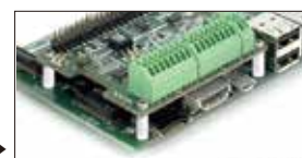
RaspberryPi CM3用キャリアボード [RPI-CM3MB3] に装着した例 ▶
