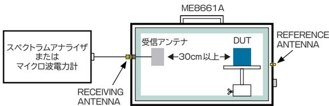
この無線系試験は、DUTをアクリル台の上に置き、これと対向した位置に取り付けられた受信アンテナの出力をスペクトラムアナライザやマイクロ波電力計等に接続して行います。したがって、この試験を行うときは、オプションの受信アンテナが別途必要になります。受信アンテナは、スパイラルアンテナとホーンアンテナを用意していますが、これら以外の仕様のアンテナを取り付ける場合は、使用周波数帯域と偏波方式の指定により対応することができます。また、DUTと受信アンテナとの距離は30cm以上とすることができます。
