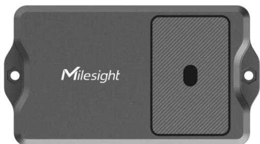
EM400-TLDはToF(飛行時間)ベースの距離センサで、主に充填レベルや位置状態の検出に使用されます。最大視野角 $27^{\circ}$ の適切なFOVにより、小型のゴミ箱やコンテナに設置しても死角がほとんどありません。温度センサーが内蔵されているため、セキュリティのために容器が燃えているかどうかを監視できます。
