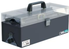
15-00014A は、インパルスノイズ試験器と組み合わせることにより、電子機器のケーブルを挟むだけでノイズを印加することができます。あわせて、本クランプを校正するためのクランプ校正治具（15-00015A）もごさいます。
