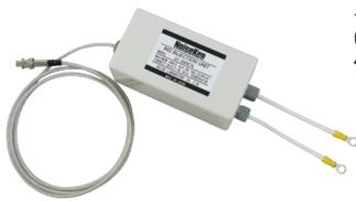
インパルスノイズ試験器のパルス出力を試験器内部の CDN を通さずに直接印加するためのユニットです。ボックス内部に CDN と同じカップリング用のコンデンサを内蔵しています。
