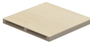
床置き機器に対するインパルスノイズ試験を行なう際に、機器をグラウンドプレーンより10cm浮かすために使用します。
