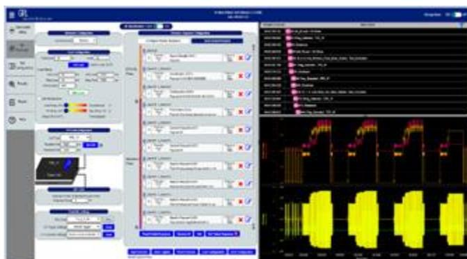
Granite River Labsのテスターは、無線充電のプロトコルだけでなく、電圧および電流を可視化し、デバッグ作業やFAILの修正が容易に行える、Wireless Power Consortiumの正式認可テスターです。
