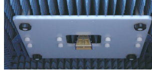
アンテナ固定台 最大5つのホーンアンテナを取付可
