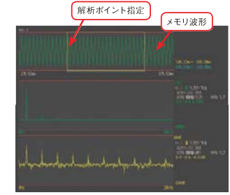
演算元(メモリ波形)とFFT演算結果の同時表示
