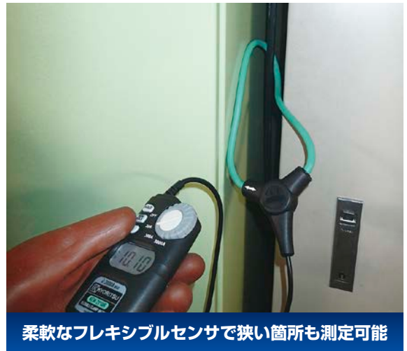
CAT IV現場の電線の込み合った場所で測定可能
