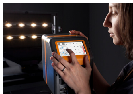
Smart Touch™ ユーザーインターフェースにより、ProMetric G2 イメージング色度計のセットアップを素早く行えます
