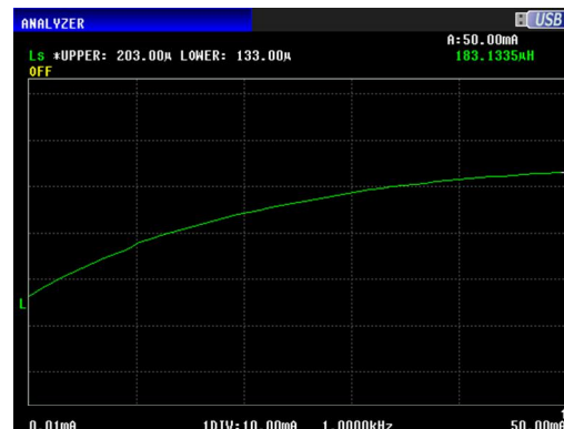
電流特性の測定例 (アナライザモード)
