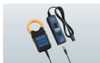
クランプオン AC/DC センサ CT9691-90 φ35mm, AC/DC 100 A, 精度: ±1.5%rdg.±1.0% f.s. DC, 45 ~ 66Hz において コード長 2m ¥43,000 (税抜き)
