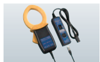
クランプオン AC/DC センサ CT9693-90 φ55mm, AC/DC 2000 A, 精度: ±2.0%rdg.±0.5% f.s. (DC) ±1.5%rdg.±0.5% f.s. (45 ~ 66Hz) コード長 2m ¥52,000 (税抜き)
