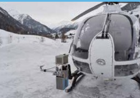
道路や鉄道、ヘリコプタなど、さまざまな移動体にシステムを搭載し、フレキシブルな設定で利用できる測量技術です
