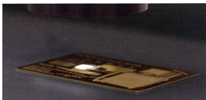
同軸照明とリング照明の2種類の使い分けが可能
