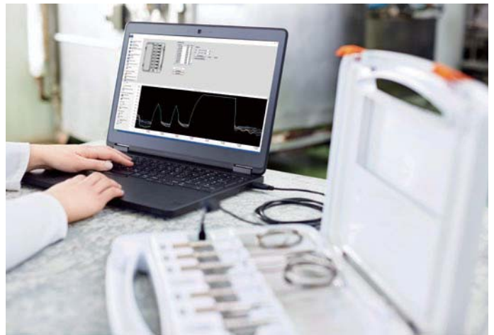
PC接続時は、ケースとPCを同梱のmini-USBケーブルで接続
