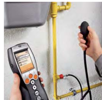
ガスパイプ圧テストセットを接続し、リーク率テスト、メインテスト、プレテスト、リーク検出の試験を実行
