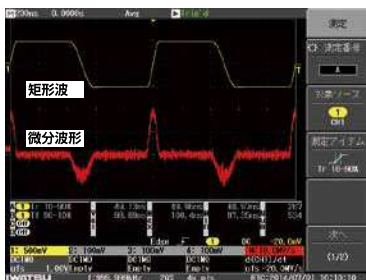
矩形波 (立上り: 50ns, 立下り: 100ns) に対する微分演算波形 (矩形波エッジ部の時間変化の大きさ (dv/dt) を表示しています。)
