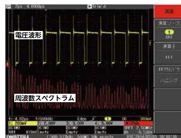
周波数スペクトラム解析 (スイッチング電圧波形のFFT演算)
