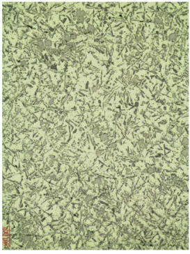
Etial 160 アルミニウム 倍率：100x
