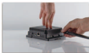
ゲートウェイにアンテナを接続
