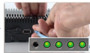
測定器とゲートウェイをLANケー ブルにて接続。LEDの4つ目が 点灯（測定器接続）
