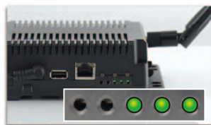
AC アダプターを接続。LED が3つ点灯（サーバー接続、 回路接続、電源）
